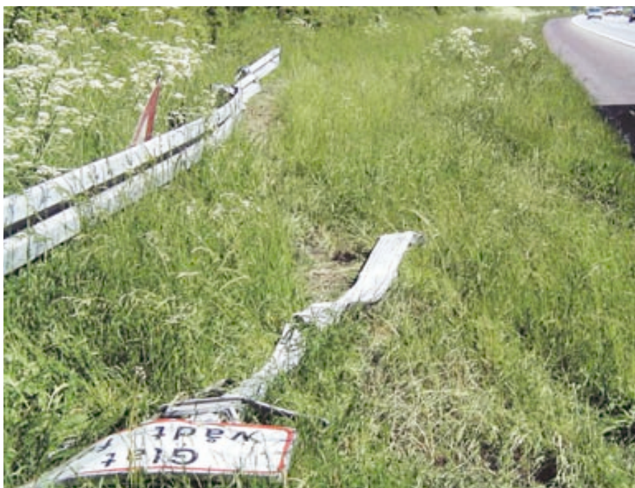
Figur 4. Den eftergivelige mast er trykket helt flad i hele dens længde og tavlerne er mere eller mindre revet af.
