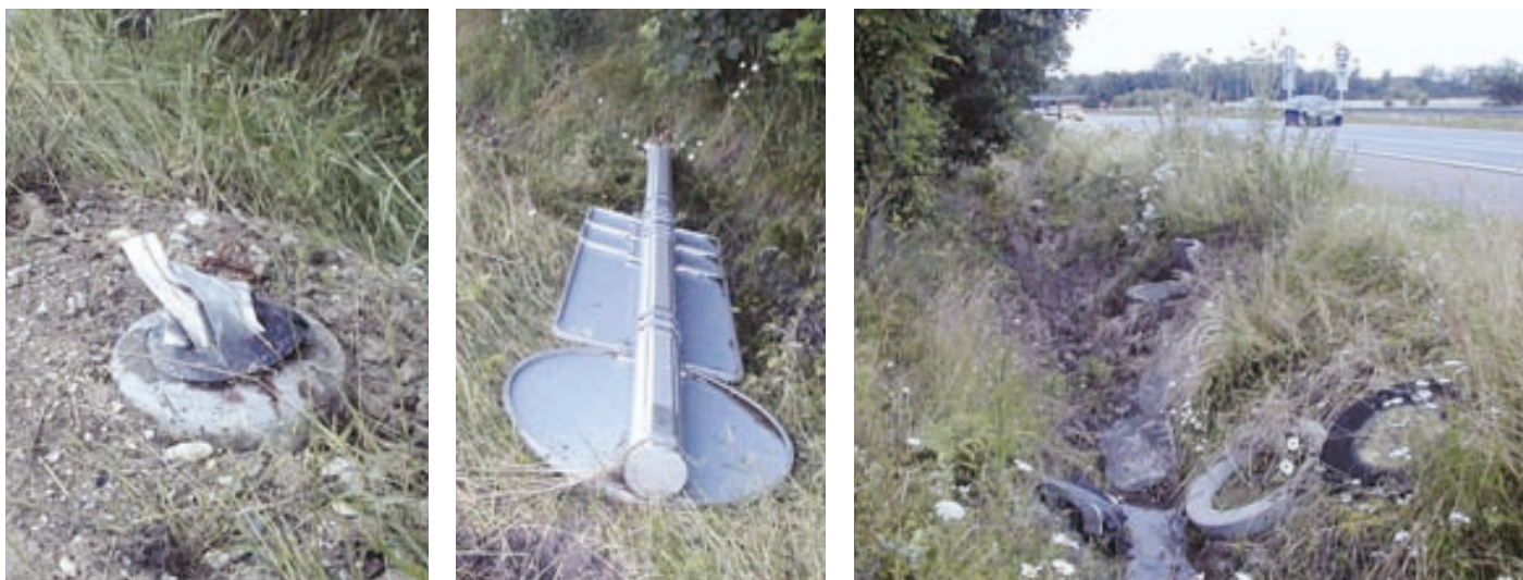
Figur 3. Første billede viser fundamentet, hvor masten er "klippet" af. Næste billede viser resten af masten (næsten uskadt) liggende i grøften lidt længere fremme. Sidste billede viser, hvor langt bilen er fortsat i grøften, inden den blev bragt til standsning af betonkeglen. Den påkørte mast stod på linie med de øvrige tre master i billedets øverste venstre hjørne.
