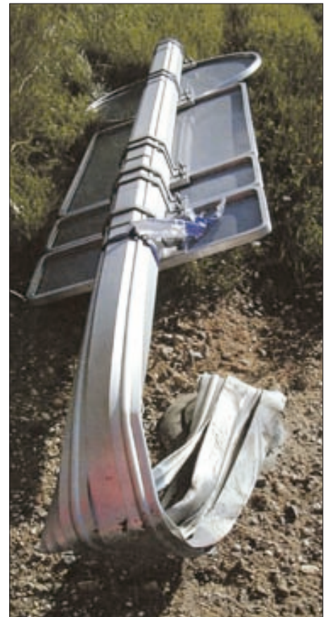
Figur 2. Frontkollision af eftergivelig mast med personbil.
