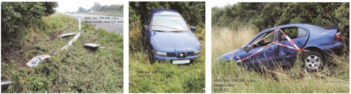
Figur 5. Første billede viser mast efter påkørsel. Næste billede viser uheldsbilen set fra front, hvor den stort set er uskadt. Sidste billede viser, hvor lidt uheldsbilen blev beskadiget, og dermed også hvor lidt bilen blev bremset i forbindelse med påkørslen.
