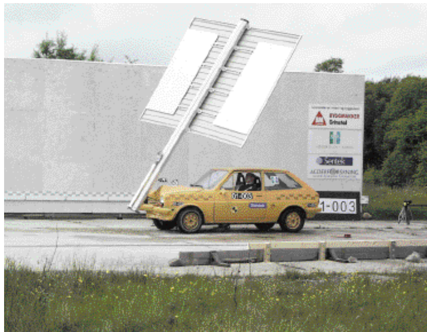
Figur 1. Påkørselsforsøg med en eftergivelig mastetype, aluminiummast med brudled, udført efter EN 12767. Hastighed 35 km/h.
